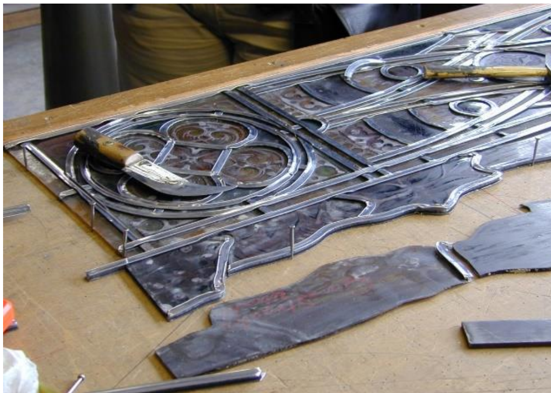
Glas-in-loodpaneel tijdens het verloden; op de voorgrond de nog niet gezette gebrandschilderde glassdelen.
